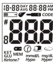
2. Überprüfen Sie den Display, um zu bestätigen, dass alle Display-Segmente eingeschaltet sind (siehe Displaydarstellung oben).
