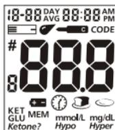
2. Überprüfen Sie den Display, um zu bestätigen, dass alle Display-Segmente eingeschaltet sind (siehe Displaydarstellung).
